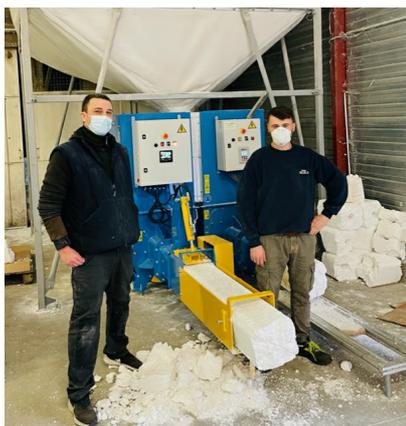
Mise en place d'un broyeur-compacteur Polystyrène
